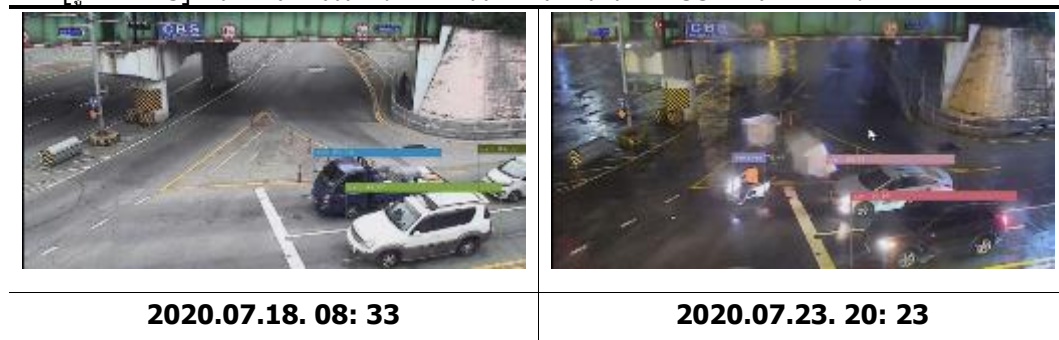
[รูปที่ 2-43] ตัวอย่างของรถยนต์เพื่อตรวจจับโดยใช้ระบบ CCTV เมื่อเกิดฝนตก
