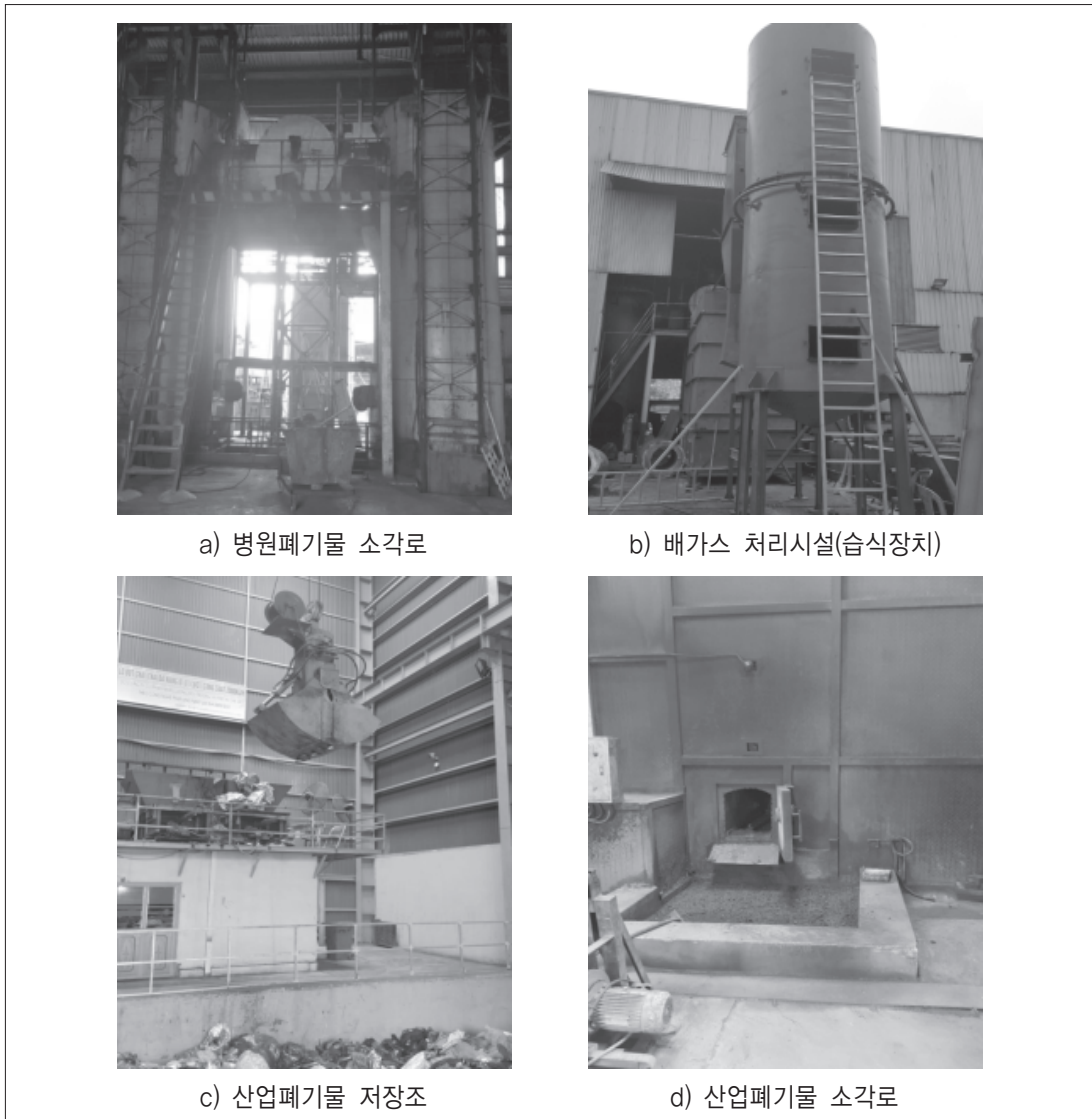
그림 2-19 | URENCO-11에서 설치 운영 중인 산업폐기물 소각시설
