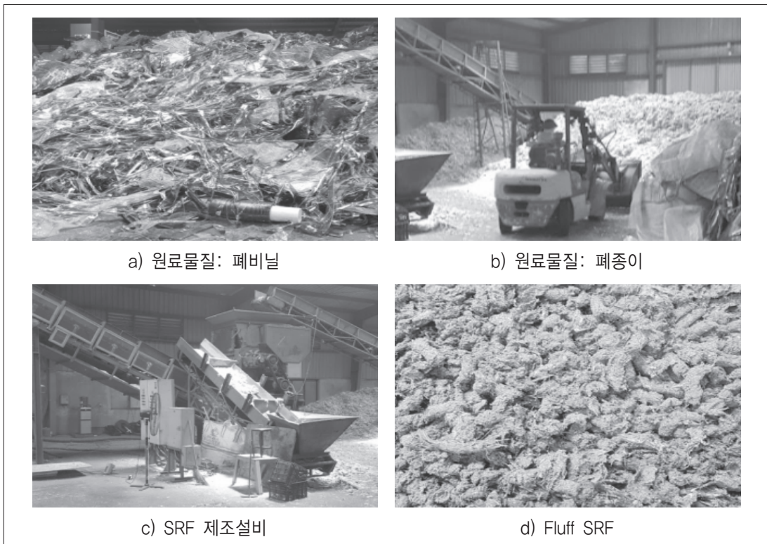
■ 그림 2-17 | URENCO-11에서 설치 운영 중인 SRF 제조시설
